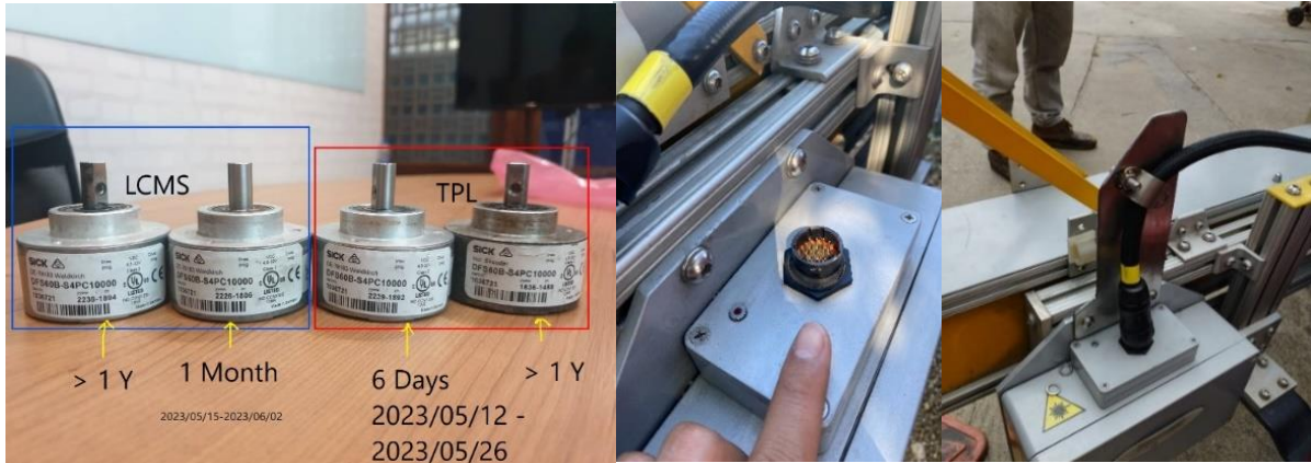
รูปที่ 2-8 อุปสรรคอุปกรณ์พังระหว่างการสำรวจ
