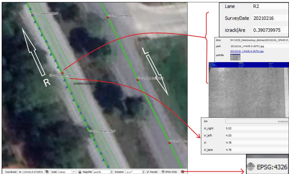
รูปที่ 1-75 แสดงการประมวลผลการสำรวจในรูปแบบแผนที่ (GIS) ข้อมูลที่เกิดความเสียหายสัมพันธ์กับค่าเฉลี่ย IRI ที่สูงตามข้อมูลประเมิน
