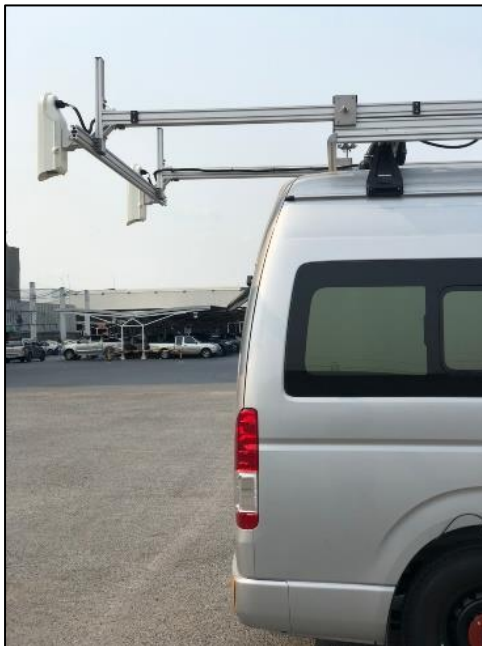
รูปที่ 1-20 กล้องบันทึกภาพผิวทาง และตัวอย่างภาพจากกล้องบันทึกภาพผิวทาง
