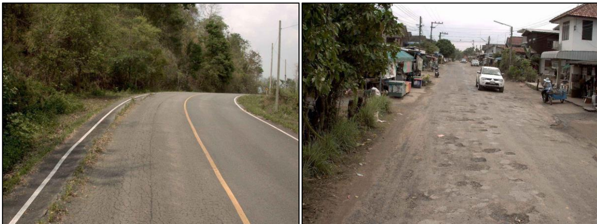
รูปที่ 1-122 ตัวอย่างสภาพผิวทาง 0 – 10 คะแนน Failed
